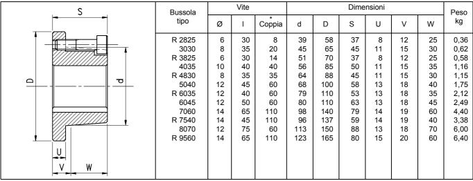
Le bussole precedute da una R possono anche essere montate in modo reversibile.
